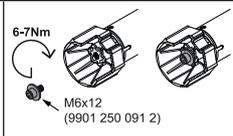
Montage und Demontage des Mitnehmers mit Schraubverbindung
