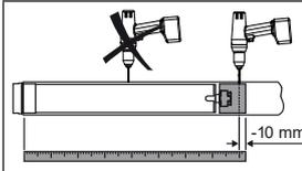
Um eine sichere Übertragung des Drehmomentes bei **Rundwellen** sicherzustellen, empfehlen wir den Mitnehmer mit der Welle zu verschrauben (siehe nachfolgende Tabelle).
