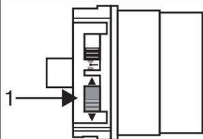
Schieben Sie den Drehrichtungsschalter (1) in die gegenüberliegende Position.
