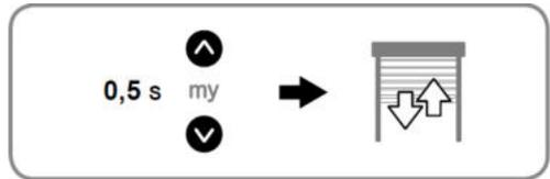
ⓘ Diese Vorprogrammierung wird gelöscht, wenn die Stromversorgung des Somfy Rollladenmotors unterbrochen wird, bevor eine Somfy Bedienung definitiv eingelernt ist (siehe Punkt 2. 3. 5).
