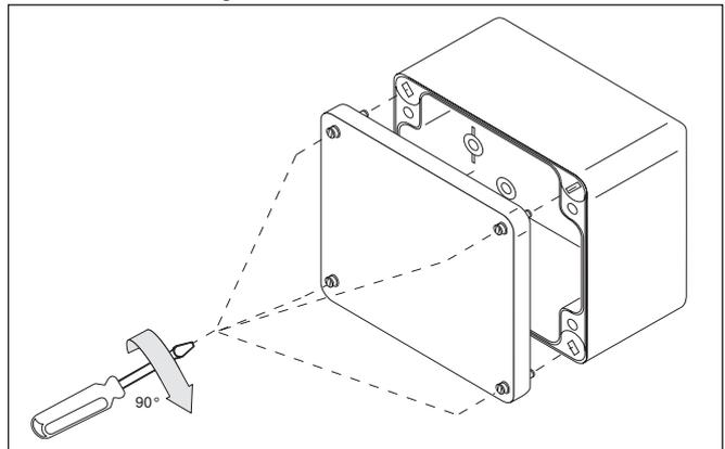
Abb. 3 Gehäuse schließen
